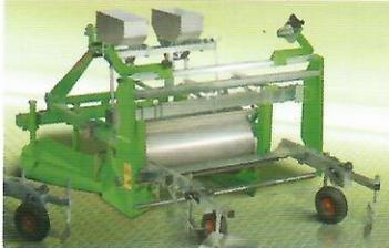
**AB** - Служит для формирования гряд при помощи двух боковых лемехов и уплотняющего катка. Очень прочная рама позволяет машине работать на любом типе почвы. Обладает высокой скоростью работы и возможностью регулировки по высоте и ширине. Модель AP способна за один проход сформировать гряду и замульчировать почву пленкой или укрывным материалом.
