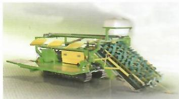
**RAPID SL** – это самоходная машина для уборки кустовых овощей. Оснащена дизельным двигателем Kubota (50 л.с.), автопилотом и металлическими гусеницами, которые позволяют двигаться по любому типу почвы (влажная, неровная). Машина может работать как на замульчированной, так и на открытой почве, а также на грядках или ровной поверхности.
