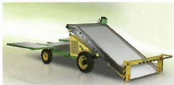
**SLIDE FW** - самоходная машина с 4 цилиндровым двигателем Kubota (32 л.с.), предназначена для уборки зеленных культур (шпинат, салат, петрушка и др.), но, в отличие от **SLIDE TW**, оснащена 4 ведущими колесами. Машина была разработана специально для теплиц, но, благодаря полному приводу, может успешно работать на открытом грунте и даже на очень влажной почве.
