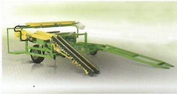
**RAPID T** - Прицепная однорядная машина для уборки кустовых овощей. Оборудована системой со срезающей головкой с зубчатым диском, который непрерывно вращается, что поддерживает его в чистом виде и предохраняет продукцию от загрязнения. Две транспортные ленты перемещают продукцию на рабочий стол, где она очищается, укладывается в ящики или поступает в бункер или прицеп.
