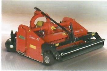
**AF** - Фрезерный грядообразователь AF SUPER оснащен передним ротором с вертикально расположенными ножами, которые измельчают почву, не изменяя ее натуральную структуру. Задний ротор с маленькими зубьями вращается в противоположную, относительно переднего вала, сторону. Благодаря высокой скорости вращения он измельчает крупные комья, а самые большие направляет на передний ротор. Таким образом, осуществляется выравнивание поверхности почвы с лёгким уплотнением.
