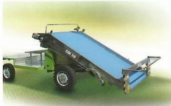
**SLIDE ECO** - это самоходная машина, предназначенная для уборки овощных листовых культур на срез, с электрическим принципом работы, и следовательно, без вредных выбросов в окружающую среду. Slide Eco оснащена электрическим двигателем, который развивает мощность 30 кВт, с питанием от аккумулятора, обеспечивающего автономный режим работы машины в течении 14 рабочих часов.
