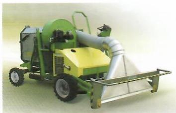
**HOOVER** - самоходная модель разработана для вакуумной уборки зеленных культур предназначенных для переработки, и ее принцип работы заключается во всасывании частей растений и всех листьев с поверхности почвы. Оснащена срезной лентой с электрогидравлическими сенсорами, лезвия которой вращаются на самоцентрирующихся роликах, покрытых резиной, что гарантирует отличный срез и долгий срок службы ножей.
