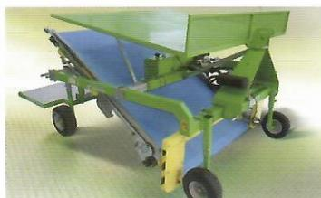
**SLIDE T** - прицепная машина для уборки мелколистных салатов и зелени. Минимальная необходимая мощность трактора 50 л.с. Дополнительно может быть оснащена пропорциональным электрогидравлическим сенсором, который гарантирует отличный контроль высоты среза без повреждения продукции, а также системой для порядковой уборки.
