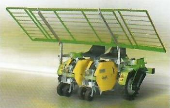
**OVER** - Многофункциональная рассадопосадочная машина для работы с рассадой из кассет с ячейками кубической, конусной или пирамидальной формы, а также луковиц и семян на предварительно замульчированном или открытом грунте. Отличительной особенностью данной модели является отсутствие сошника на высаживающем аппарате вертикального типа.
