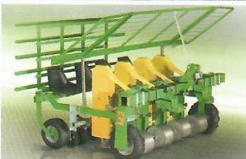
**EASY MANUAL** - Рассадопосадочная машина для работы на открытом грунте с автоматической или ручной подачей рассады. Система с ручной подачей предназначена для высадки рассады из кассет с ячейками кубической, конусной или пирамидальной формы, а с автоматической – только кубической формы. Высаживающие аппараты вертикального типа установлены независимо друг от друга, что позволяет поддерживать одинаковую глубину работы на любом типе почвы.
